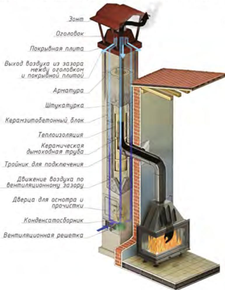
Мы рекомендуем устанавливать с нашими топками многослойную керамическую систему дымоудаления «ECOOSMOSE». Многослойная, керамическая система дымоудаления ECOOSMOSE обеспечит безопасный отвод продуктов горения от Вашего теплогенерирующего аппарата в течении всего срока эксплуатации. Она подходит для каминов, печей-каминов, банных печей и котлов с применением различных видов топлива (природный газ, дрова, уголь, пеллеты и др.).
